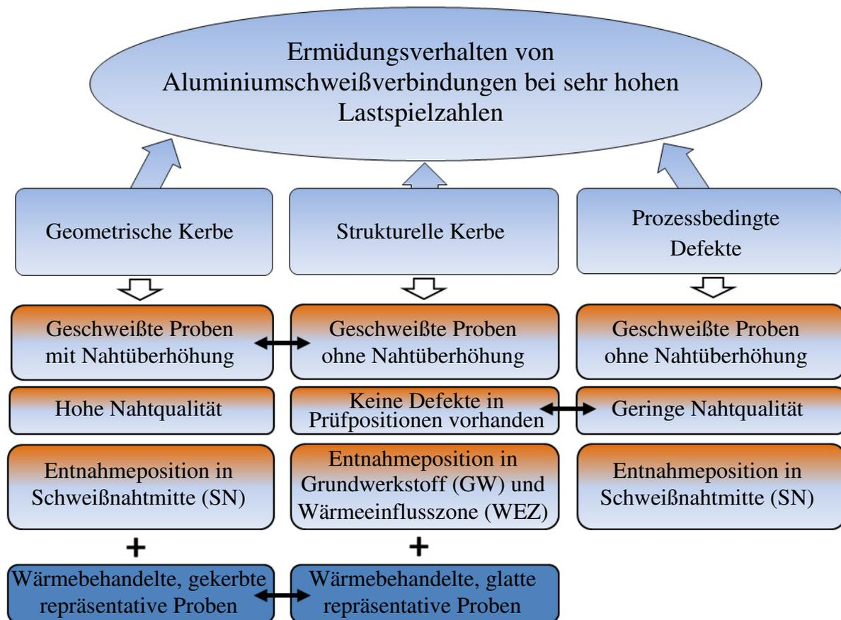
Abbildung 1-2: Übersicht der zu untersuchenden Kerbfaktoren auf das Ermüdungsverhalten von Aluminium-Schweißverbindungen im Bereich sehr hoher Lastspielzahlen und die zur Separierung dieser Kerbeffekte verwendeten geschweißten und nicht geschweißten, wärmebehandelten repräsentativen Proben.
