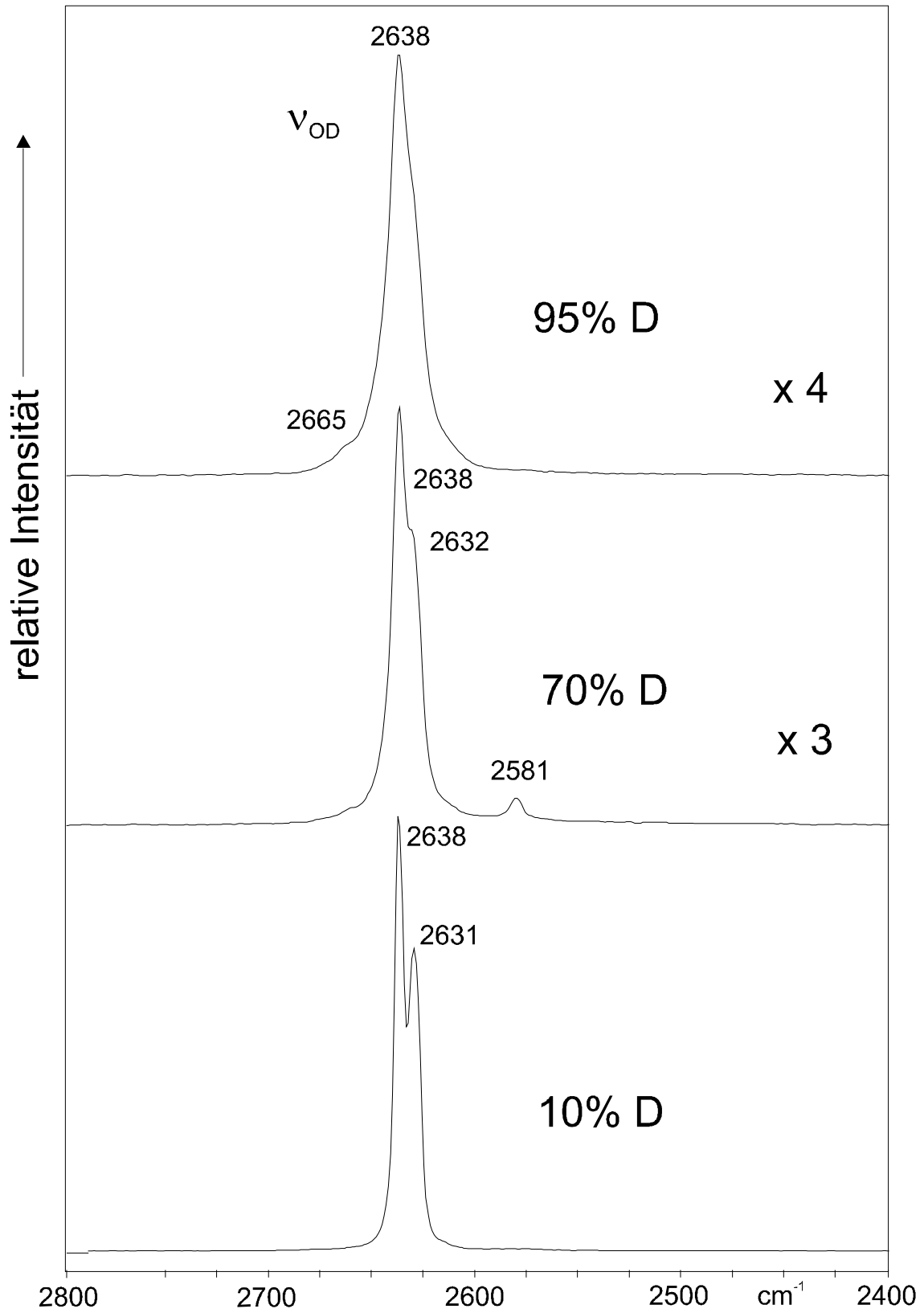
Abb. 8.8: Ramanspektren von \beta\text{-Mn}_2(\text{OH}_3)\text{Cl} im Bereich 2400 – 2800 \text{cm}^{-1} .
