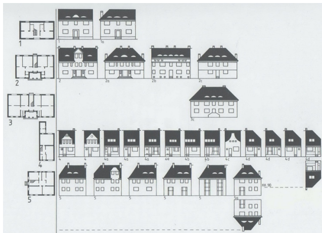
Gartenstadt Staaken, Haustypen und Varianten der ersten Bauphase, 1914/15. Zeichnung Karl Kiem u. Eva Boemans
