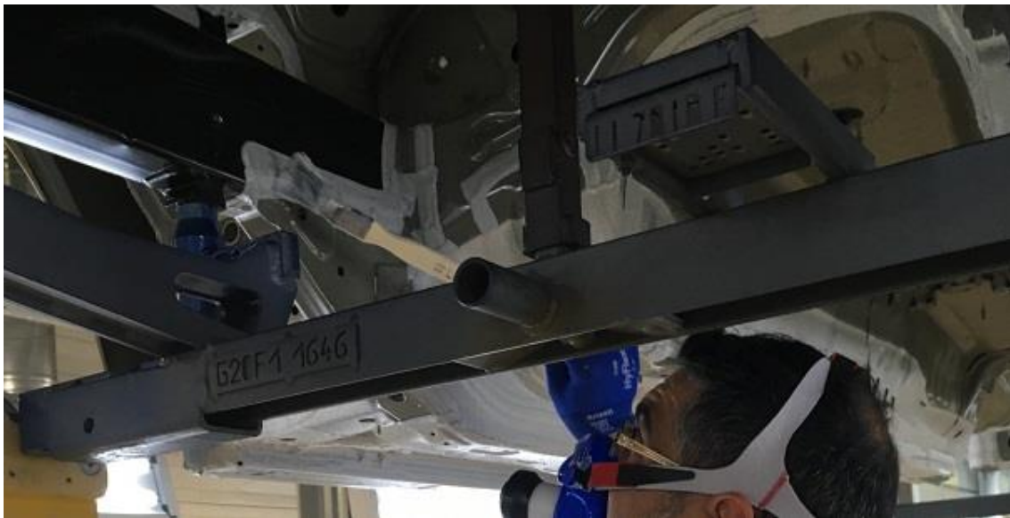
Abbildung 55: Manueller Nahtverstrich am Radlaufauslauf unten, Radlaufauslauf oben links und am Metallfalz (von links oben nach rechts unten)
