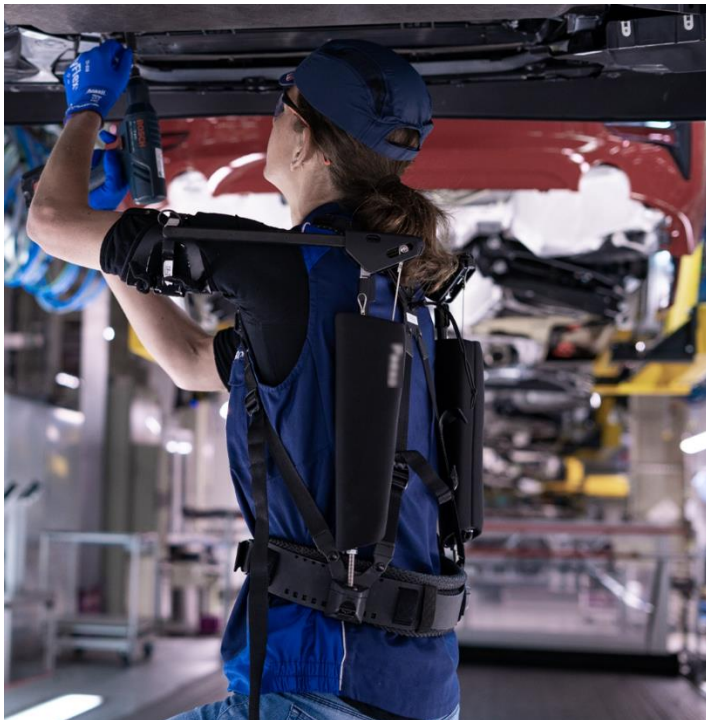
Abbildung 9: Passives Überkopf-Exoskelett in der Automobilmontage (links); idealisierte Unterstützungsbereiche von Überkopf-Exoskeletten, grün: optimal, gelb: eingeschränkt, rot: keine Unterstützung (SkelEx, 2017)
