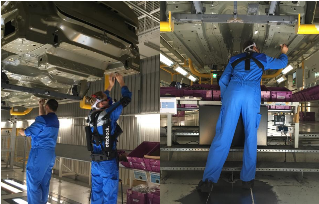
Abbildung 54: Unterbodenstopfen setzen mit (links) und ohne Exoskelett (rechts) sowie angelegter Messtechnik
