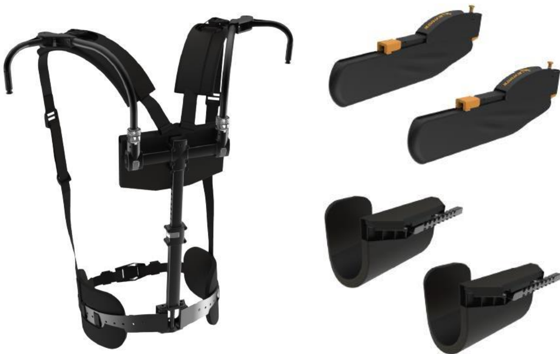
Abbildung 25: Levitate Airframe™. Stützender Rahmen inkl. Becken- und Schultergurte (links). Kassetten mit Federmechanismus (rechts oben). Einstellbare Armschalen (rechts unten) (Levitate Technologies, 2018)
