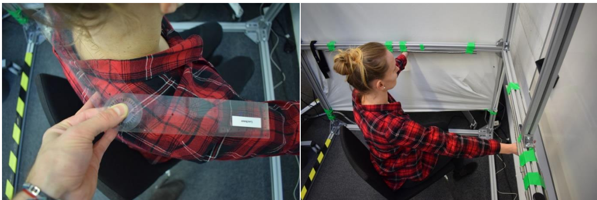
Abbildung 35: MVC-Normalisierung des Musc. deltoideus pars clavicularis für das NIRS-Verfahren; links: Kontrolle des Abduktionswinkels; rechts: Haltung während der Durchführung
