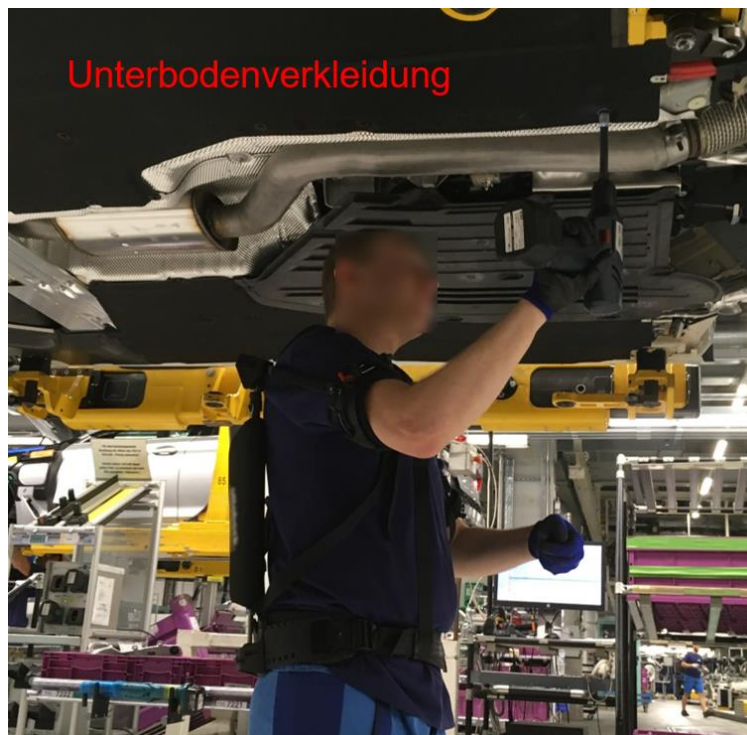
Abbildung 27: Mitarbeitender bei der Verschraubung der Unterbodenverkleidung.
