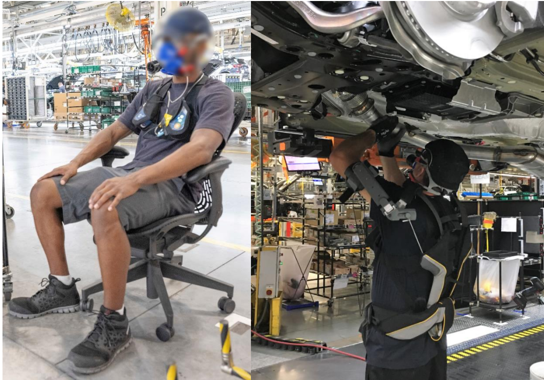
Abbildung 62: Erfassung der Ruhewerte vor Versuchsbeginn (links) sowie manuelle Befestigung des Abgastaktes am Abgasstutzen des Antriebsaggregats in Überkopfarbeit mit angelegtem Exoskelett (rechts)
