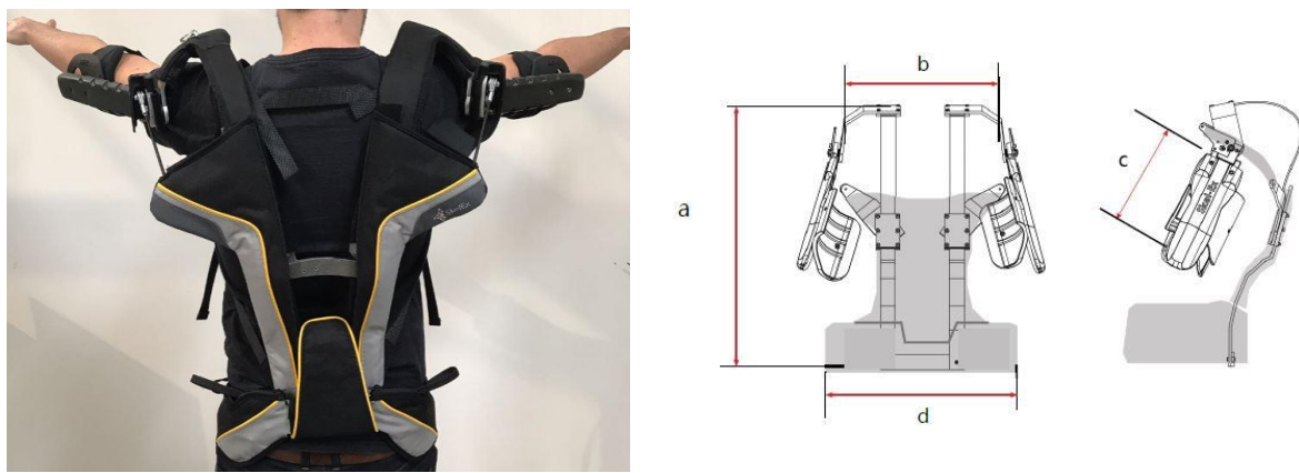
Abbildung 24: SkelEx V1, Model 2017. Exoskelett im angelegten Zustand (links) (Clavel, 2017). Technische Zeichnung inkl. variabler Abmessungen (rechts) (SkelEx, 2017)
