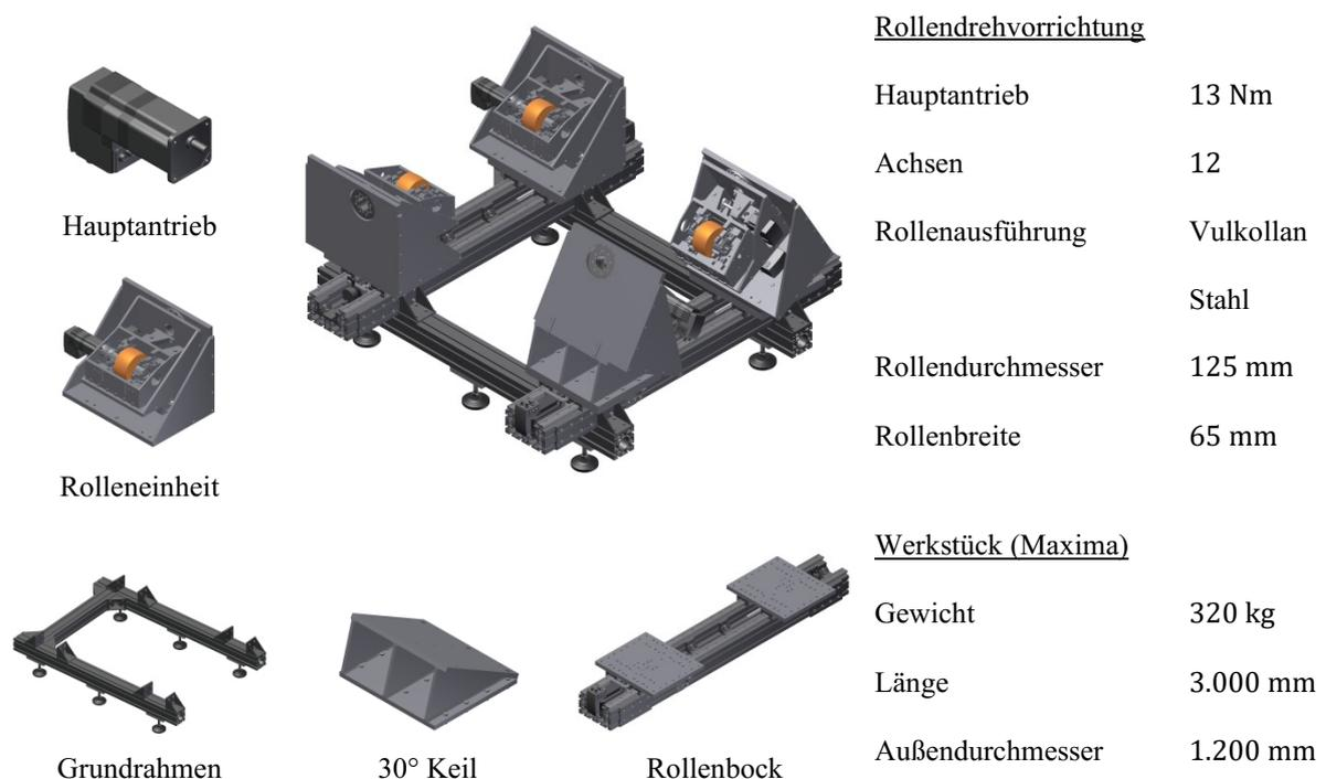
**Abb. 6.2** 3D-CAD-Darstellung des entwickelten Versuchsstandes mit Baugruppendetails und technischen Daten.
