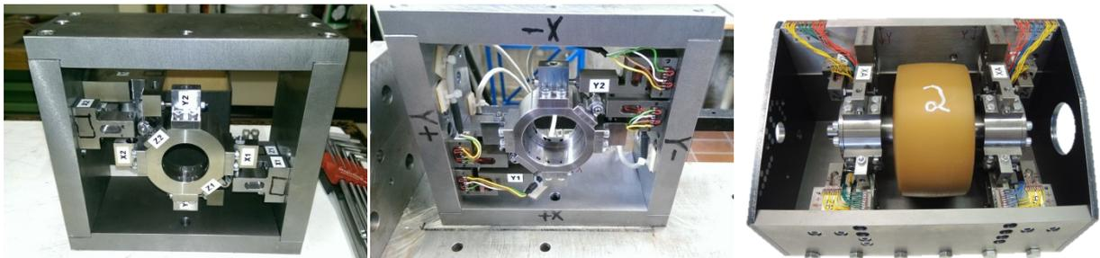
**Abb. 6.13** Prototyp des 3D-Kraftaufnehmers eingebaut in einem Testgehäuse (links: Außenseite nicht verkabelt, mittig: Innenseite mit applizierten DMS und Verkabelung bis zu den Lötstützpunkten) und eine beispielhafte Rolleneinheit (rechts).
