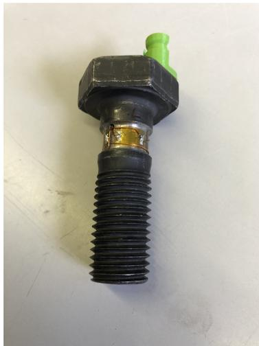
**Abbildung 5.5:** Präparierte M16x50 Schraube mit Zugentlastung (hellgrün) sowie am Schraubenschaft angebrachte DMS
