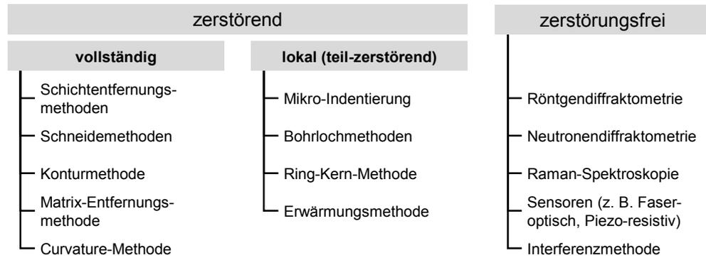
**Abbildung 2.4** – Methoden zur Ermittlung von Eigenspannungen [24, 25]
