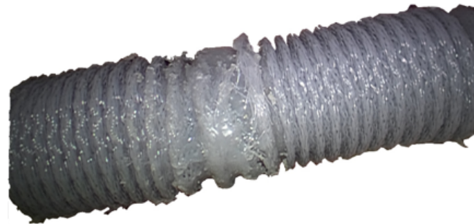
Abbildung 7.1: Erste Version des STIFF-FLOP Armes, bestehend aus 2 Arm Segmenten mit einer gewobenen äusseren Hülle. Quelle: Projekt Newsletter
