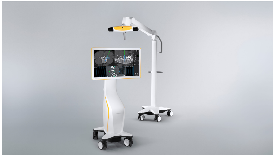
Abbildung 4.6: Das „Curve Navigation“ System der Firma Brainlab, bestehend aus einer Stereokamera und einem Monitor zur Visualisierung von Instrumenten. copyright: Brainlab AG, Quelle: [21]
