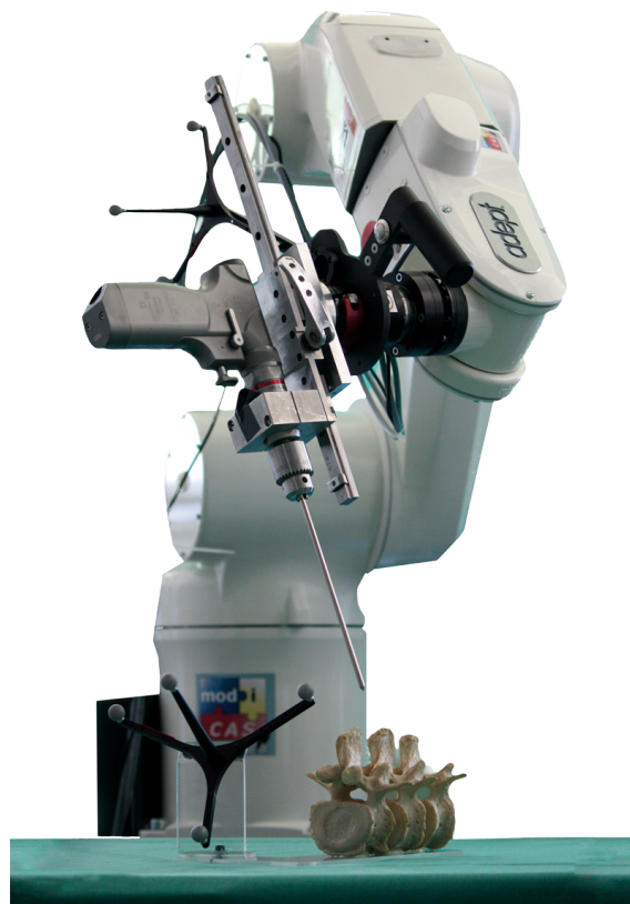
Abbildung 6.2: Das chirurgische Assistenzsystem MODICAS, mit einer Führung für chirurgische Instrumente am Endeffektor [95]
