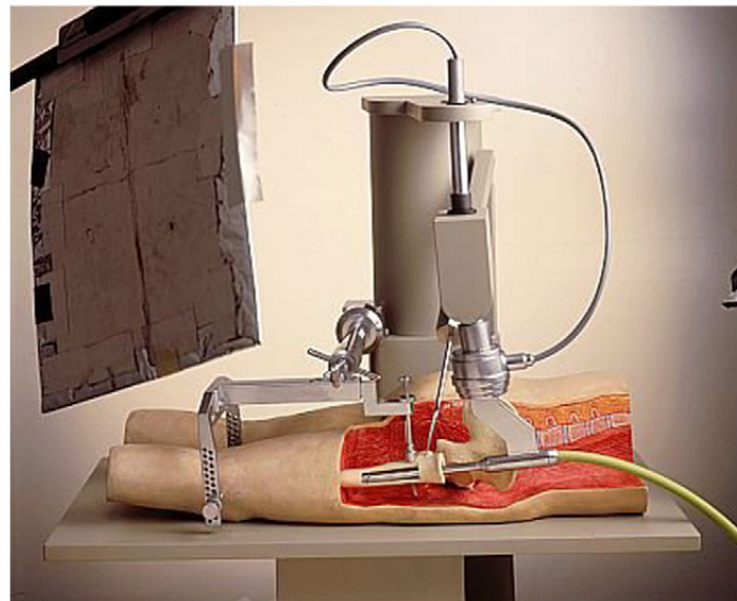
Abbildung 2.1: Das von Integrated Surgical Systems entwickelte ROBODOC System zum Ausfräsen des Femurschaftes für Hüftprothesen [67]
