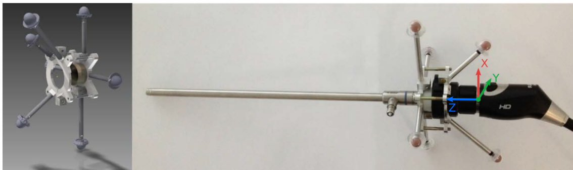
Abbildung 7.5: Modell des Versteifungselements für die Endoskopkamera mit Haltern für Markerkugeln (links) und das gefertigte Element an der Endoskopkamera (rechts) mit dem festgelegten Koordinatensystem, Quelle: [64]
