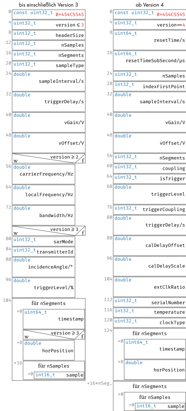
Abbildung C.1: Struktur der Radarrohdaten des HITCHHIKER-Empfängers.
