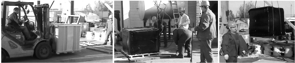
Abbildung 7: Clovertainer. Derartiges Bitumenhandling kann bei hohen Temperaturen problematisch sein (Greif NZ Ltd)
