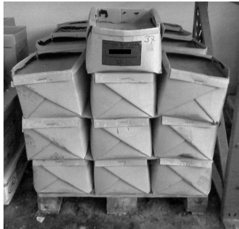
Abbildung 26: Kartonverformung bituminöser Fugenvergussmassen im Hochbau
