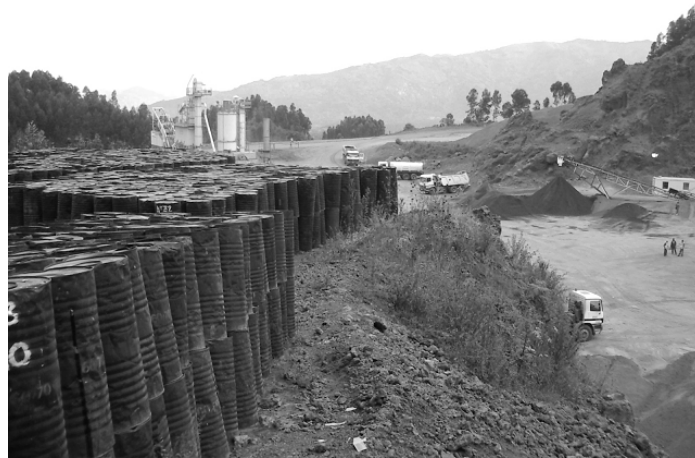
Abbildung 11: Bitumenfässer nach Entleerung auf einer Asphaltmischanlage in Ruanda (Archivbild STRABAG SE)
