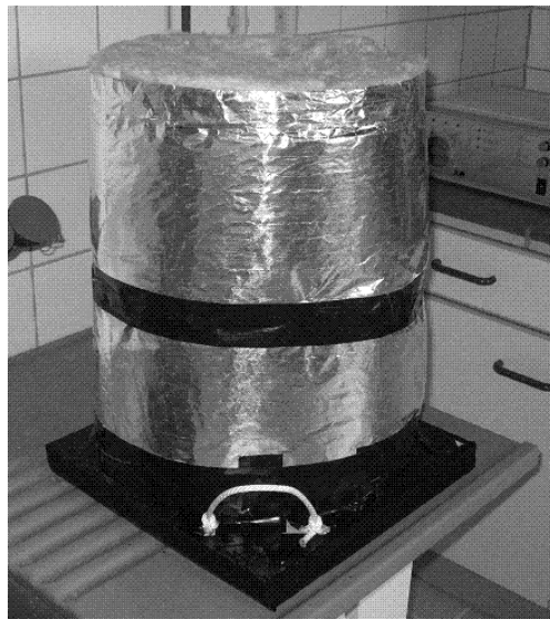
Abbildung 51: Dämmung für den Eimer, in dem sich die Schmelze beim Aufschmelz-/Abkühlversuch befindet
