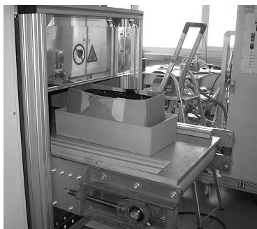
Abbildung 104: Eingang des Durchlaufofens der Versuchsanordnung 3 (Maße des Kartons: 40 cm × 20 cm × 20 cm)
