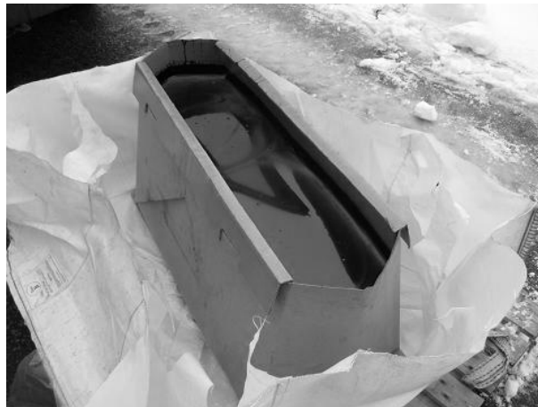
Abbildung 23: Kartongebinde nach Abkühlung und Entfernen des Bügels
