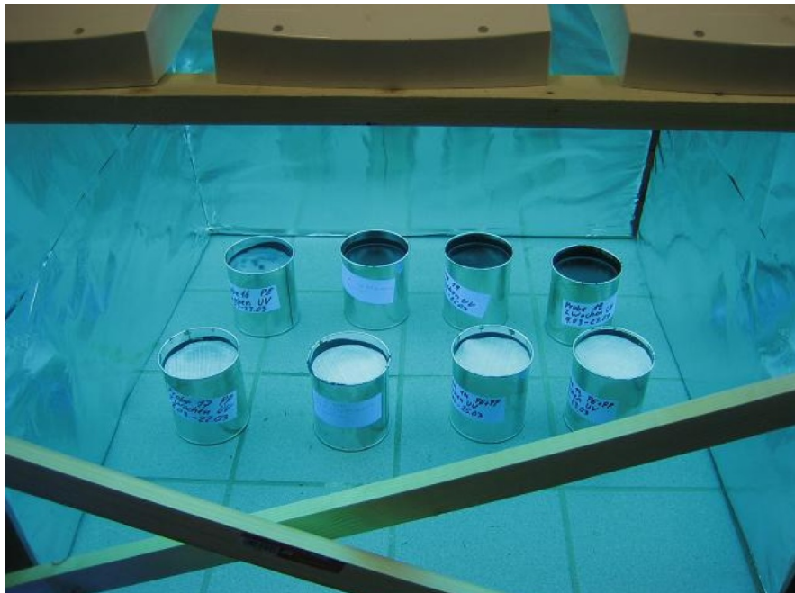
Abbildung 37: Bitumenproben mit und ohne Verpackungsfolie unter UV Bestrahlung
