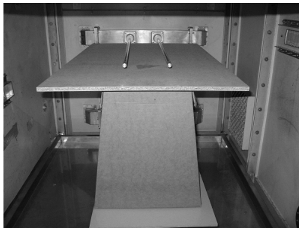
Abbildung 86: Darstellung des Ortes der Pressholzplattenerwärmung
