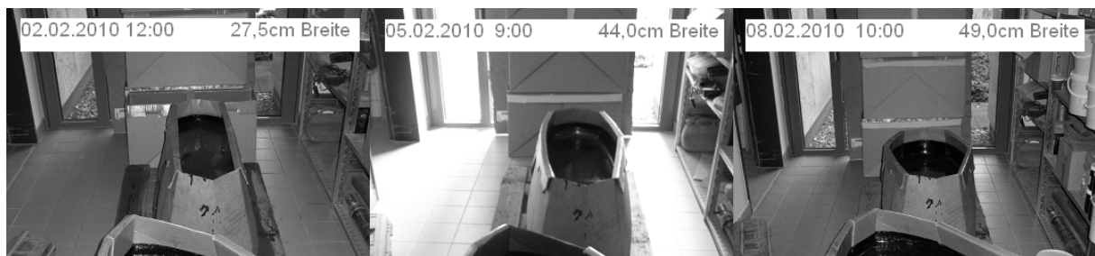
Abbildung 24: Bitumenverformung im Kaltzustand trotz Gegendruck durch die Kartonverpackung
