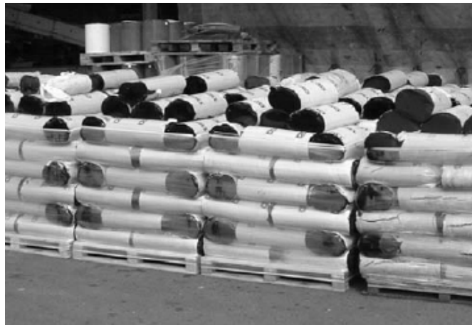
Abbildung 13: Einfache Kunststoffolie als Trennmittel gegen das Adhäsionsverhalten (Archivbild STRABAG SE)
