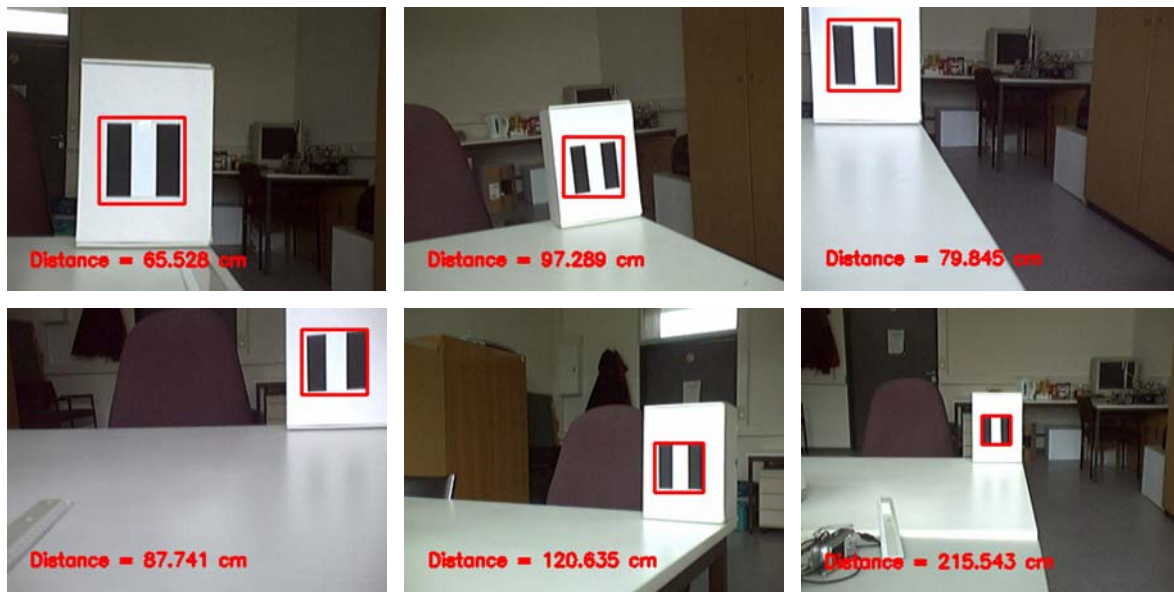
Abb. 6.5: Bestimmung der Pose aus verschiedenen Distanzen und Blickwinkeln zwischen 2D-Kamera und künstlichen Land- bzw. Referenzmarke [122] [123].
