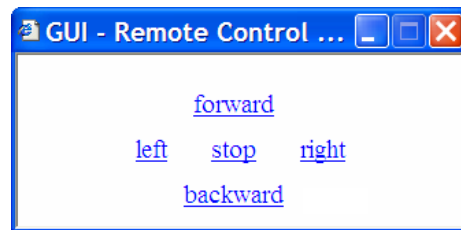
Abb. 4.12: Remote-Control-GUI zur Fernsteuerung eines mobilen Fahrzeugs via Internet. Die Http-Links der Textelemente sind aus Tab. 4.2 erstellt.
