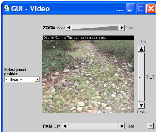
Abb. 4.11: Video-Control-GUI zur Video-betrachtung des Fahrwegs im Frontbereich des mobilen Fahrzeugs via Internet mittels schwenkbarer Web-Kamera [136].
