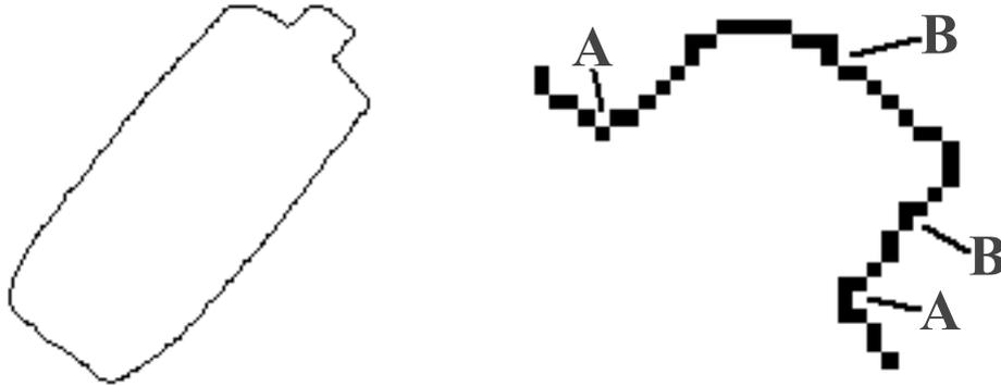
Abbildung 3.2: Auf der rechten Seite ist eine Vergrößerung des Kappenbereiches der Flaschenaußenkontur auf der linken Seite zu sehen. Die Konturpunkte sind 8er-Nachbarn. Mit **A** sind Stellen starker konkaver Krümmung und mit **B** sind Stellen schwacher konkaver Krümmung gekennzeichnet.
